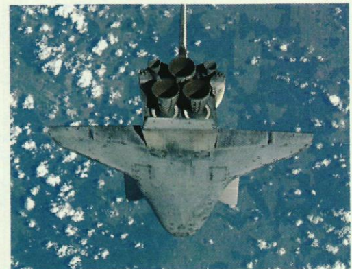
Doc. 16 La navette spatiale est munie d'un bouclier thermique qui la protège lors de son entrée dans l'atmosphère.
